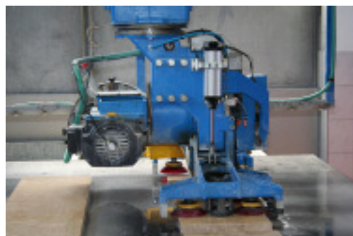
Die Vakuumplatten werden in Arbeitsstellung durch Druckluftzylinder arretiert.
