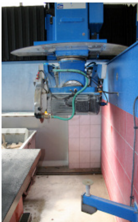
Hochgeklappte Vakuumplatte mit Stempeln für den Werkstückanschlag
